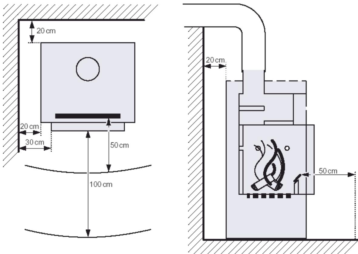
Вплотную к стенам можно устанавливать только те тепловые приборы, которые для этого предназначены и в инструкции по эксплуатации которых содержится прямое указание на возможность такой установки.
